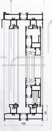
Rotura de Puente Térmico realizada con poliamidas de
